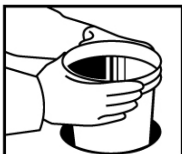
Da: Fjern montereringen. Eng: Remove the mounting ring
